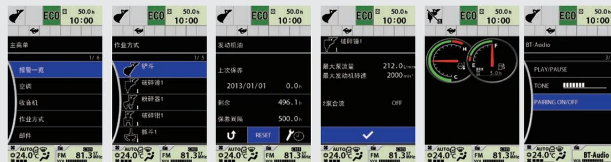
主菜单      作业方式      发动机油      破碎锤设定      破碎锤运转小时数      蓝牙配对
